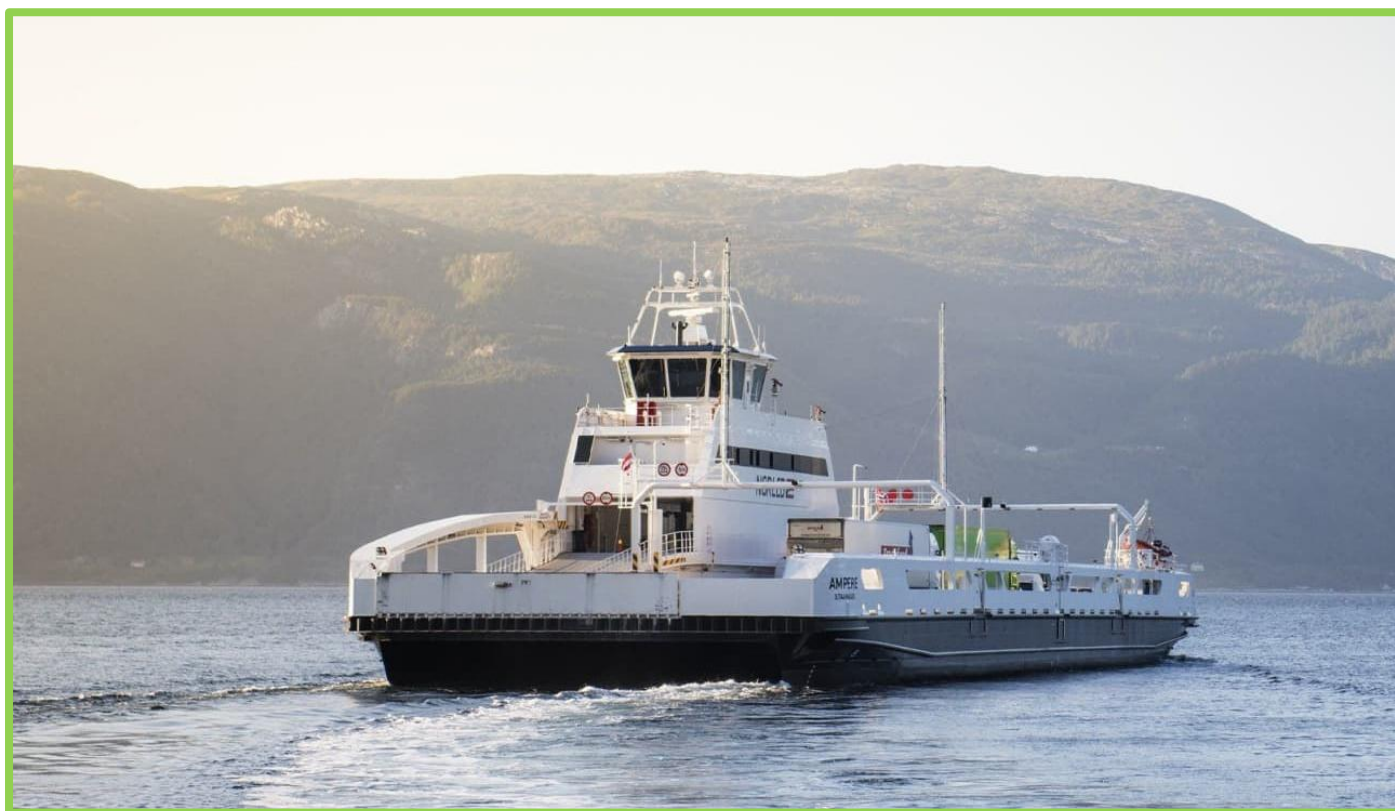
Catamarán eléctrico 'MV Ampere', primer ferry a batería del mundo. Puesto en servicio en Noruega en el año 2015. Tiene una capacidad para llevar hasta 120 coches y 12 camiones disponiendo de una batería de 1 MW. Fuente: kanebridgenews.com
